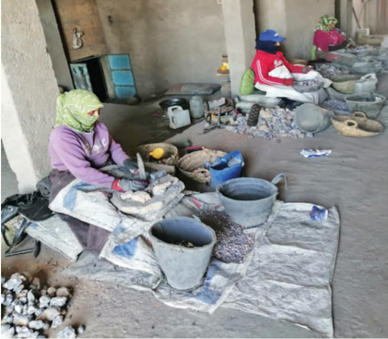
FIGURE 20.10 | RÔLE DES FEMMES : SCHEIDAGE DU MINÉRAI DE PLOMB DANS LA MINE DE PLOMB ET DE ZINC À BOUDHAR-BENI TADJIT (MERYEM EL ABIDI EL ALAOUÏ, 2022).
