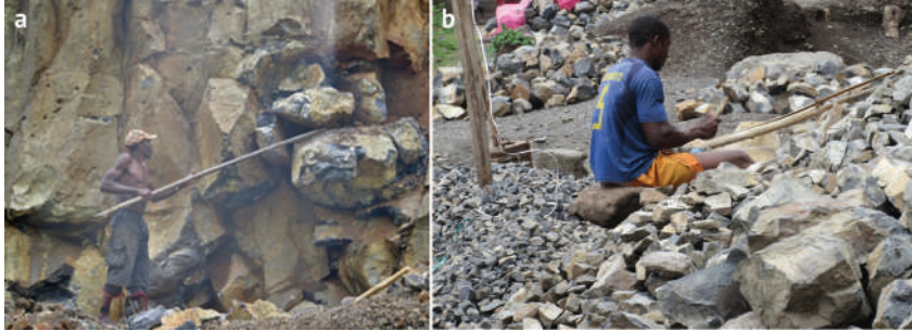
FIGURE 14.5 | (A) EXPLOITATION ARTISANALE DE BLOCS ET GRAVIERS DE BASALTE POUR LA CONSTRUCTION. (B) CONCASSAGE DE BASALTE POUR LA PRODUCTION DE GRANULATS.
