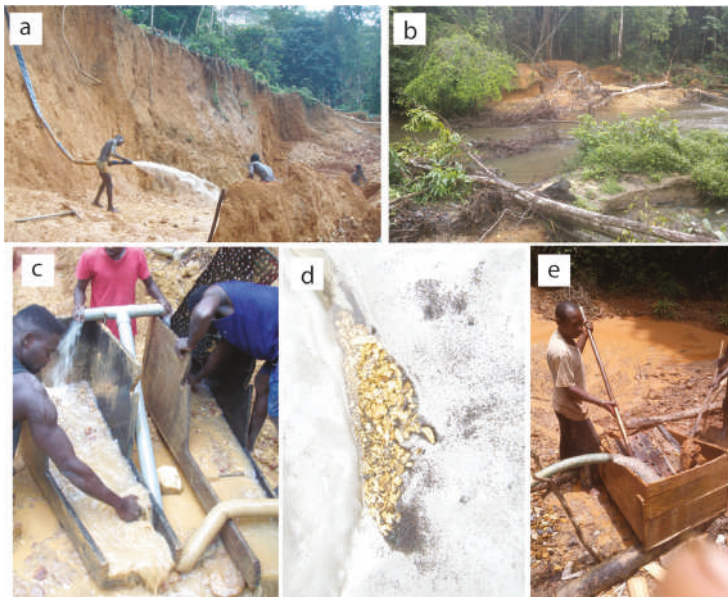
FIGURE 17.4 | EXTRACTION ET LAVAGE DU MINÉRAI AURIFÈRE GÉNÉRANT IN FINE LA MISE EN SUSPENSION DE PARTICULES DANS LES COURS D'EAU ET AUGMENTANT LEUR TURBIDITÉ, IMPACT NOCIF POUR LA BIODIVERSITÉ AQUATIQUE. (A) EXTRACTION À LANCE-MONITOR. (B) EXPLOITATION DU GRAVIER DU LIT VIF À IKOYE. (C) LACAGE DU MINÉRAI AURIFÈRE. (D) PÉPITE ET PAILLETTES D'OR APRÈS LAVAGE ET CONCENTRATION. (E) MAUVAIS LAVAGE DANS UN SLUICE TROP COURT.
