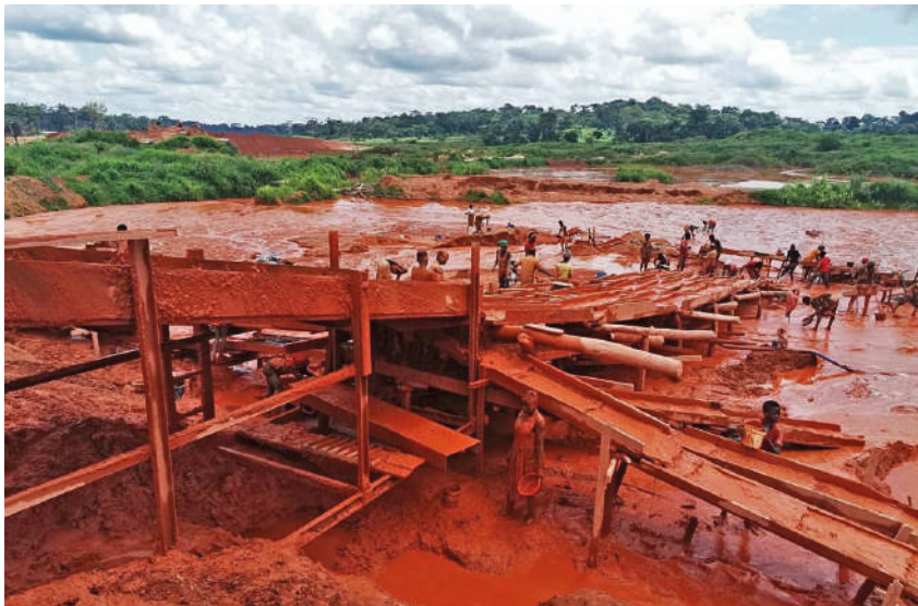
FIGURE 2.9 | LONG-TOM POUR LE LAVAGE DU GRAVIER AURIFÈRE SUR LE SITE DE BOUKAROU, KAMBÉLÉ-EST CAMEROUN (PASCALINE, 2020).
