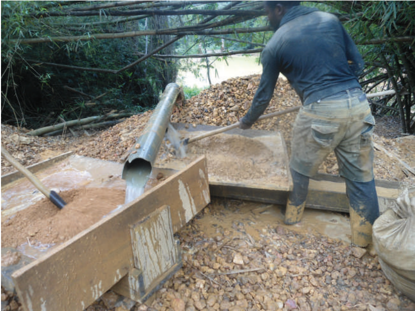
FIGURE 15.3 | LAVAGE DES SÉDIMENTS À L'EAU, AUGMENTANT PAR LA SUITE LA TURBIDITÉ DES COURS D'EAU À PROXIMITÉ.
