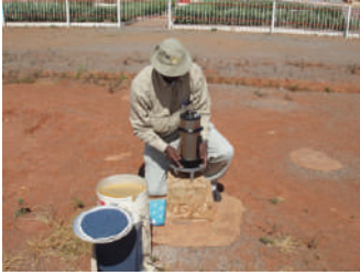
FIGURE 9.1 | PHOTOGRAPHIE PRISE EN 2007 MONTRANT LE PR. SEBAGENZI MANIPULANT LE GRAVIMÈTRE WORDEN 979 AU-DESSUS D'UN DES POINTS GRAVIMÉTRIQUES DE RÉFÉRENCE OU BASES GRAVIMÉTRIQUES DANS LA VILLE DE LUBUMBASHI EN RDC. ON PEUT VISUALISER EN AVANT-PLAN, LE CAISSON CYLINDRIQUE OUVERT, PROTECTEUR DU GRAVIMÈTRE LORS DE SON TRANSPORT. ON NOTE SURTOUT QUE LE GRAVIMÈTRE EST DÉPOSÉ VERTICALEMENT SUR SON TRÉPIED, SUPPORT QUI REPOSE LUI-MÊME SUR UNE BORNE DU NIVELLEMENT IGG (INSTITUT GÉOGRAPHIQUE DU KATANGA) MATÉRIALISANT LE POINT DE MESURE.
