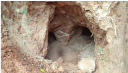
FIGURE 2.22 | TUNNELS CREUSÉS PAR LES MINEURS OÙ LE RISQUE D'ASPHYXIE PEUT ÊTRE PRÉSENT (CAPAM).
