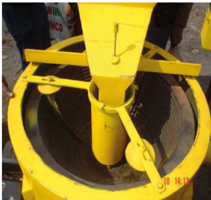
FIGURE 2.10 | CENTRIFUGEUSE DU SITE MINIER DE BINDIBA, CAMEROUN (CAPAM, 2008).
