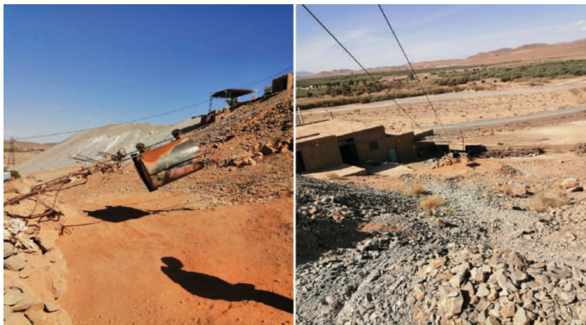
FIGURE 20.6 | TÉLÉPHÉRIQUE UTILISÉ DANS LES CHANTIERS DE PLOMB ET DE ZINC À BOUDHAR-BENI TADJIT (FATIMA SBAI, 2022).
