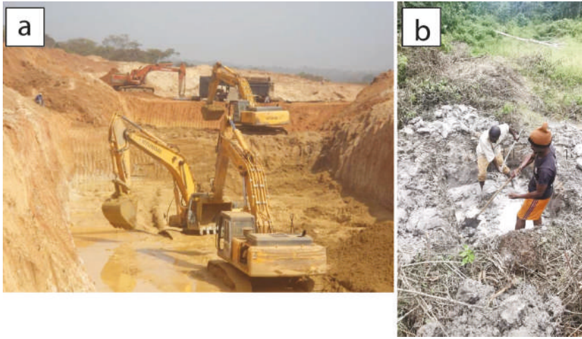
FIGURE 2.2 | CREUSAGE MÉCANIQUE (A) À COLOMINE. (B) CREUSAGE MANUEL À GARIGOMBO, EST-CAMEROUN (PASCALINE, 2022).
