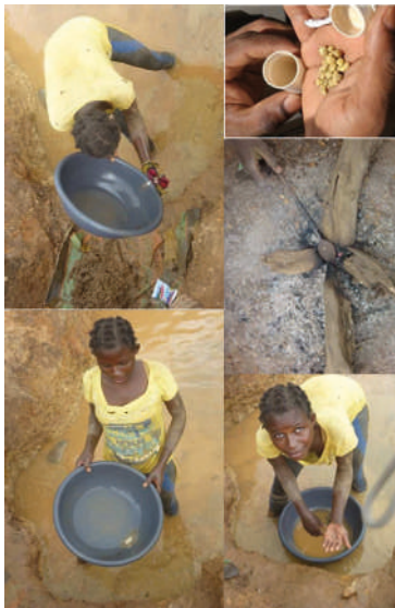
FIGURE 2.11 | ÉTAPES DE L'AMALGAMATION DE L'OR ET BRÛLAGE DE L'AMALGAME (AFEMIC, 2016).
