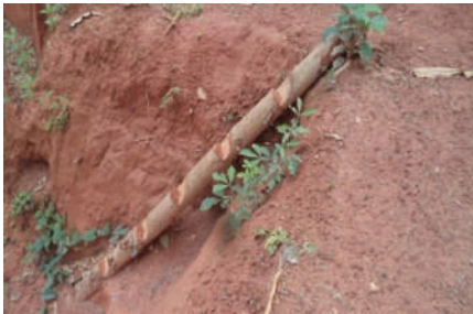
FIGURE 2.23 | ÉCHELLE TAILLÉE DANS UN TRONC ET UTILISÉE PAR LES MINEURS, MAIS DÉCLARÉE NON CONFORME (CAPAM).
