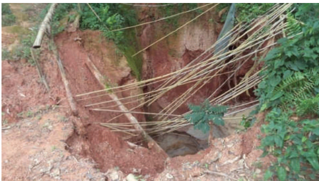
FIGURE 2.24 | EXEMPLE DE TROU AYANT PROVOQUÉ LA CHUTE D'UN MINEUR ARTISAN À CAUSE DE LA NON-CONFORMITÉ DE L'ÉCHELLE (CAPAM).
