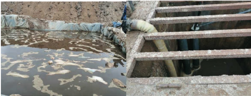
FIGURE 2.12 | CYANURATION DE L'OR SUR LE SITE MINIER DE BÉTARÉ-OYA, CAMEROUN (AFEMIC, 2021).
