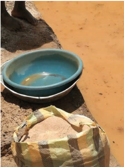
FIGURE 2.7 | PAN EN FER ET EN PLASTIQUE (PASCALINE, 2016).
