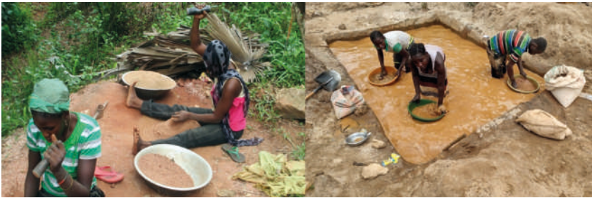
FIGURE 8.4 | TRAITEMENT DE MINERAIS PAR CONCASSAGE, BROYAGE ET LAVAGE SUR UN CHANTIER D'OR À BEKE, RÉGION DE L'EST, CAMEROUN (PAUL KEMENG, 2014).
