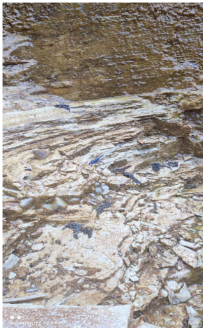
FIGURE 10.5 | ROCHE PRÉSENTANT DES PLANS DE FAIBLESSE.
