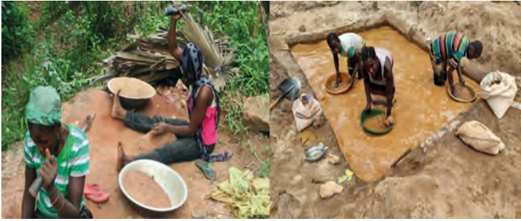
الشكل 78 | معالجة الخام عن طريق التكسير والطحن والغسيل في موقع للذهب في بيكي، المنطقة الشرقية، الكاميرون (بول كمينغ، 2014)
