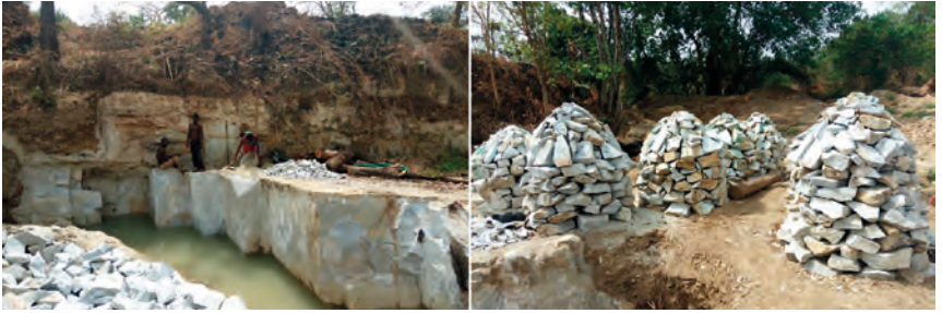
Figure 153 : à gauche : exploitation artisanale de dolomie à Nyaoulou (Cliché : Konkondji, 2018). A droite : concassage de blocs de dolomie à Nyaoulou (Cliché : Sogle, 2016).
