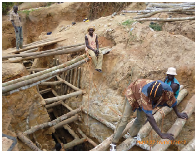
Figure 99 : Boisage des tranchées et des puits d'un site d'orpaillage.
