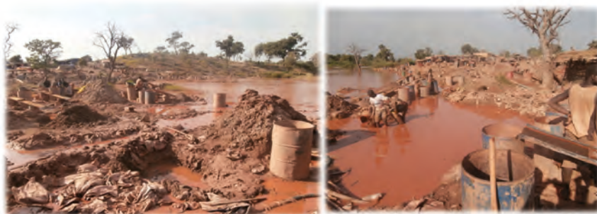
Figure 47 : Rejets de produits de cyanuration dans la Falémé (Sites minier de Toroniloto, Kéniéba, Ouest Mali).
