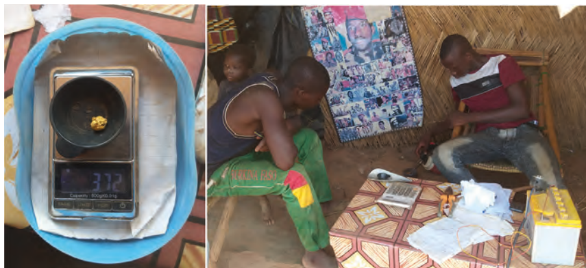
Figure 87 : à gauche : pesée d'une bille amalgamée d'or. Site aurifère de Diarkadougo, Province de Bourguiba, Région Sud-Ouest. A droite : chauffage de la bille amalgamée d'or par un acheteur d'or en présence d'un client. Site aurifère de Diarkadougo. Clichés : BUMIGEB, 2019.
