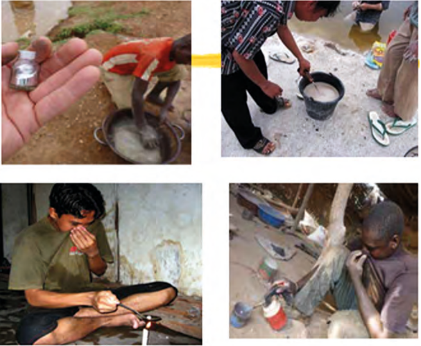
Figure 30 : Amalgamation et brûlage du mélange mercure-or (Centre de Chami).
