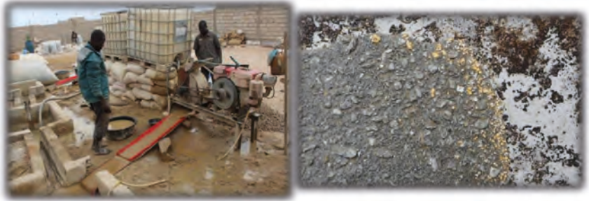
Figure 28 : Sluice amélioré couplé à un moulin (à gauche) et concentré d'or (à droite) obtenu après lavage du minéral (Mauritanie).
