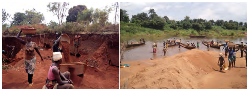
Figure 84 : à gauche : femmes opérant le traitement du tout-venant des graviers roulés par tamisage à Duvé (Commune de Dogbo, Département du Couffo, Bénin). A droite : femmes transportant le matériau sableux vers la berge sur un site d'exploitation artisanale de sable alluviale à Loko-Akankpè (Commune de Zangnanado, Département du Zou, Bénin).
