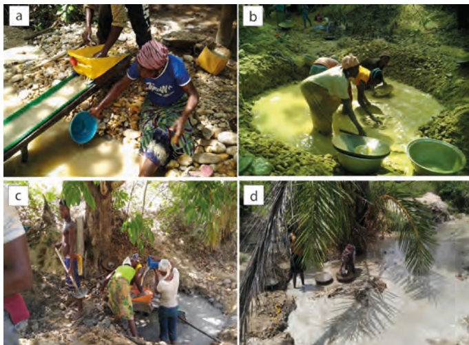
Figure 147 : Lavage du minerais au sluice de fortune à Agbandaoudè (a) (Cliché : Sogle, 2013) et à Kéméni (c) (Cliché : Boutoyi, 2019). Lavage du minerais à la batée à Agbandaoudè (b) (Clichés : Sogle, 2013) et à Agbandi (d) (Cliché : Boutoyi, 2019).
