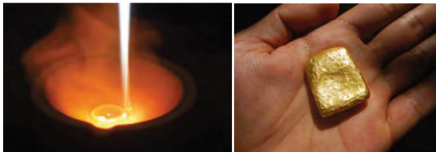
Figure 32 : Fonte de l'or spongieux pour obtenir le lingot (Centre de Chami, Mauritanie).
