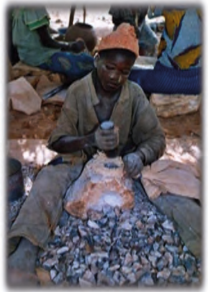
Figure 22 : Concassage au marteau des matériaux extraits des fosses et des galeries (sites du Mali).
