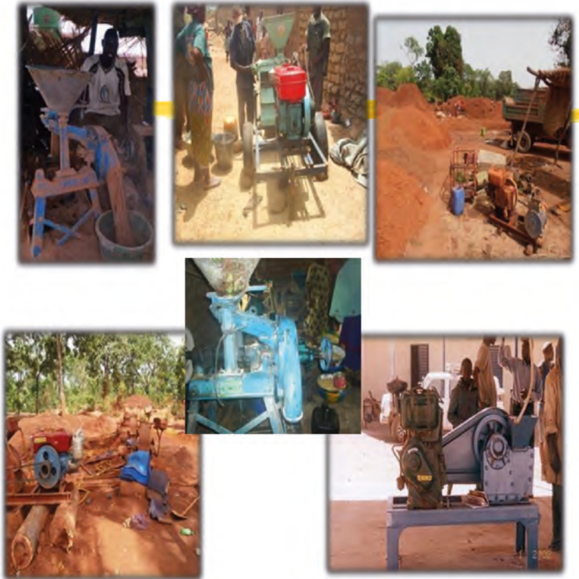
Figure 24 : Phases de concassage et de broyage du minerai avec quelques spécimens d'outils utilisés.
