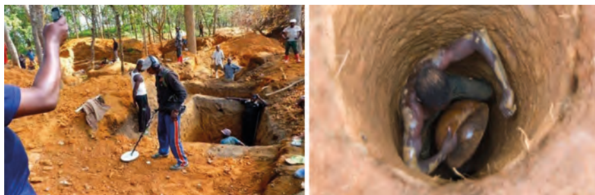
Figure 111 : à gauche : creusage d'un ouvrage rectangulaire et usage du détecteur pour la recherche de pépites d'or à Sala (Sigiri, Guinée). A droite : Creusage d'un ouvrage circulaire à Sala, Sigiri, Guinée.
