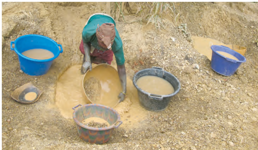
Figure 74 : Récupération de l'or avec le mercure à l'air libre sans protections.
