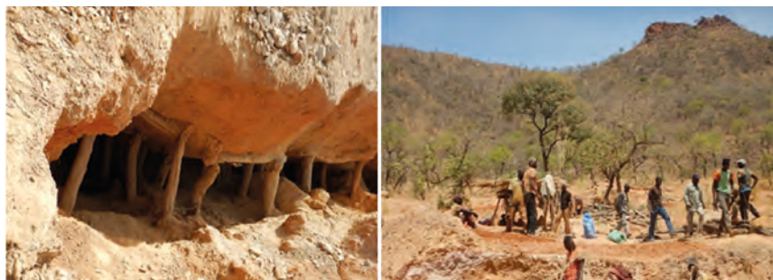
Figure 122 : Utilisation du bois pour le boisage et déforestation sur le site de Kéniéba.
