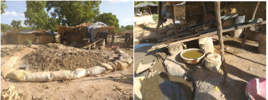
Figure 91 : à gauche : rejets issus du sluice. Site aurifère de Diarkadougou, Province de Bourguiba, Région Sud-Ouest. A droite : poste de travail de sluice ou rampe de lavage. Site aurifère de Diarkadougou. Clichés : BUMIGEB, 2019.
