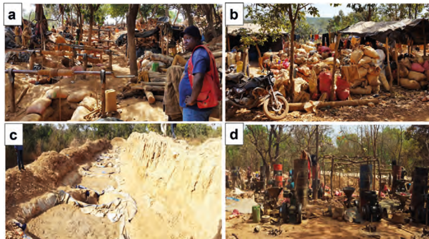
Figure 96 : Exploitation artisanale d'or en Côte d'Ivoire. (a) Equipement pour accéder à + 70 m de profondeur et pompes à haute puissance. (b) Des tonnes de minerai stockées sur plusieurs aires de stockage. (c) Lixiviation en tas artisanale : usage de cyanure. (d) Plusieurs mini-concasseurs pour broyer le minerai.
